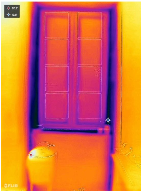
Fenêtre nue Point froid 12,9 °
