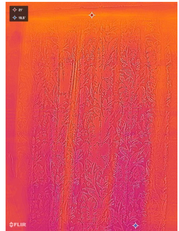
fenêtre avec doubles rideaux Point froid 19,5°
