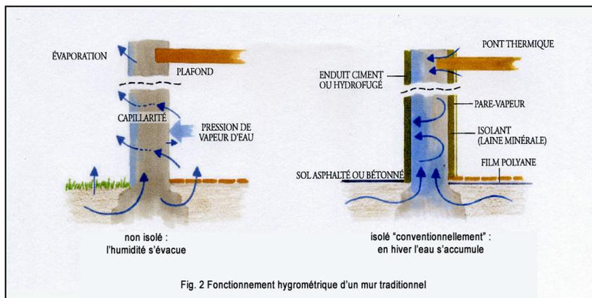
Fig. 2 Fonctionnement hygrométrique d'un mur traditionnel
