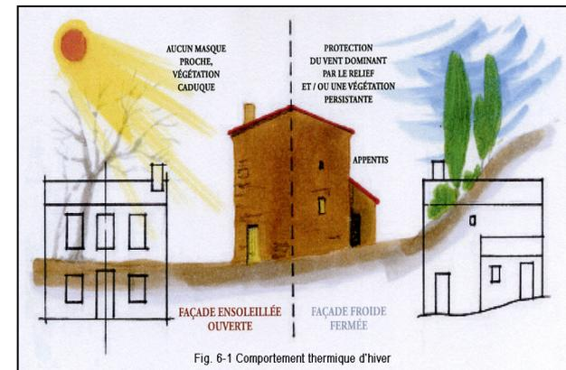
Fig. 6-1 Comportement thermique d'hiver
